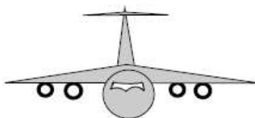
1.7.4. ábra. A repülőgép működésének nagyobb megbízhatósága érdekében 4 hajtóművet visznek
